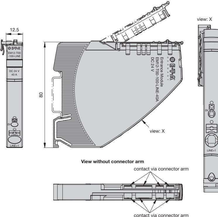
**EM12-T00-200-LINE-40A supply module centre/LINE, LINE separated**
