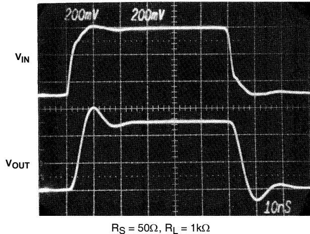
SMALL SIGNAL WAVEFORMS
