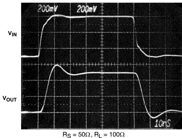
SMALL SIGNAL WAVEFORMS
