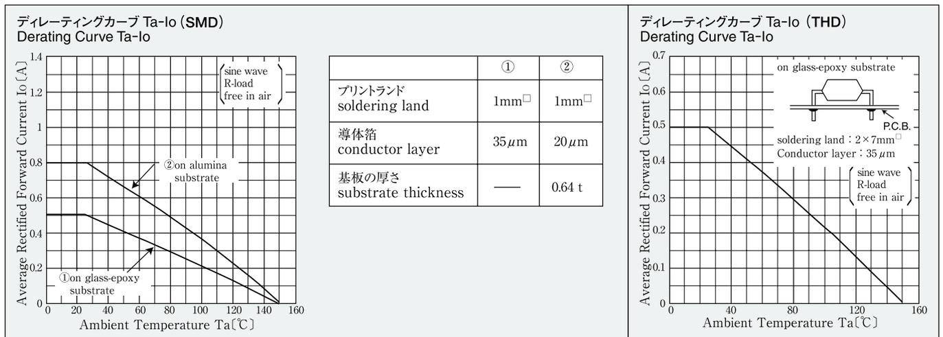
\* Sine wave は 50Hz で測定しています。
