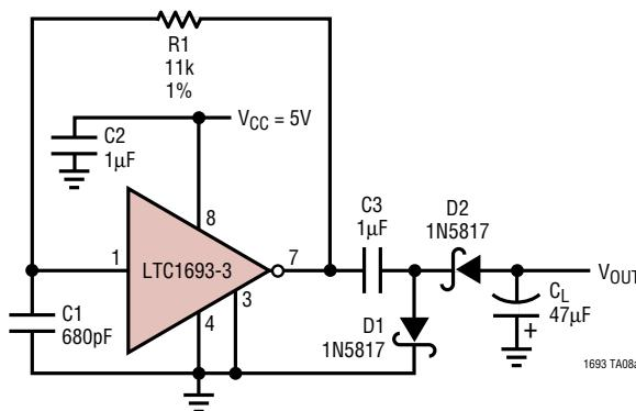
R1, C1 SET THE OSCILLATION FREQUENCY AT 150kHz
