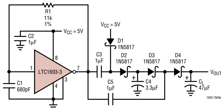
R1, C1 SET THE OSCILLATION FREQUENCY AT 150kHz
