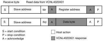
Fig. 14 - Send Byte/Receive Byte Protocol
