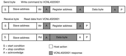
Fig. 13 - Send Byte/Receive Byte Protocol
