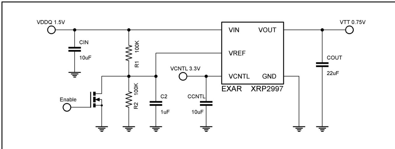
Fig. 1: XRP2997 DDRIII V<sub>TT</sub> Application Diagram
