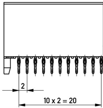
EN Zone für durchkontaktierte Löcher  $\phi 0,6 \pm 0,05$
