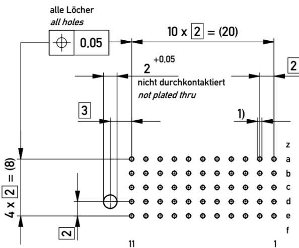
1)  $\phi 0,6 \pm 0,05$  Durchmesser des metallisierten Loches
