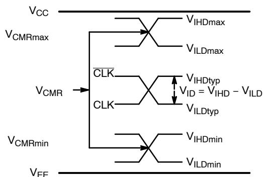
**Figure 9.  $V_{CMR}$  Diagram**
