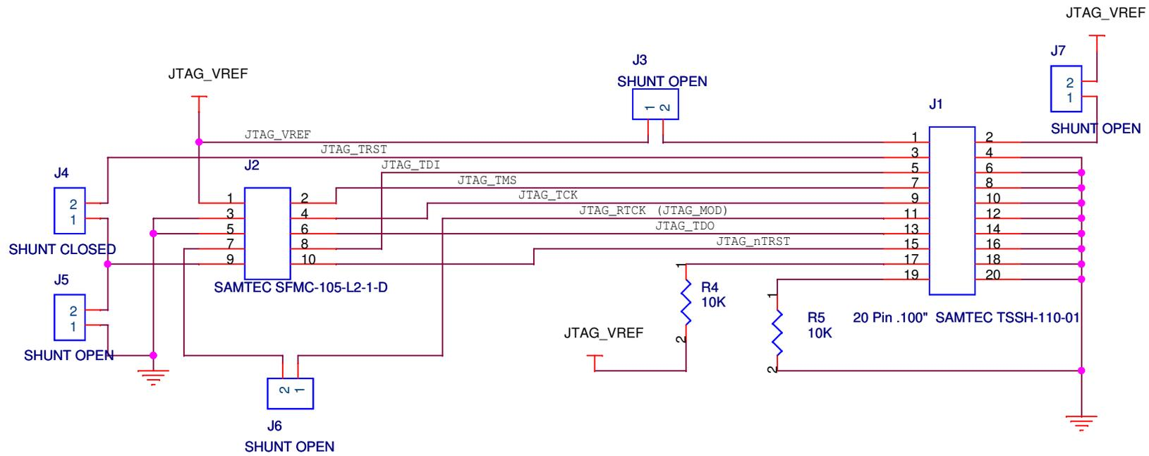
J1 PIN1 AND 2 IS THE JTAG TOOL REFERENCE VOLTAGE USUALLY 3.3V
