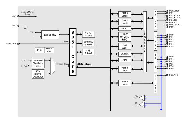
Figure 1.8. C8051F317 Block Diagram
