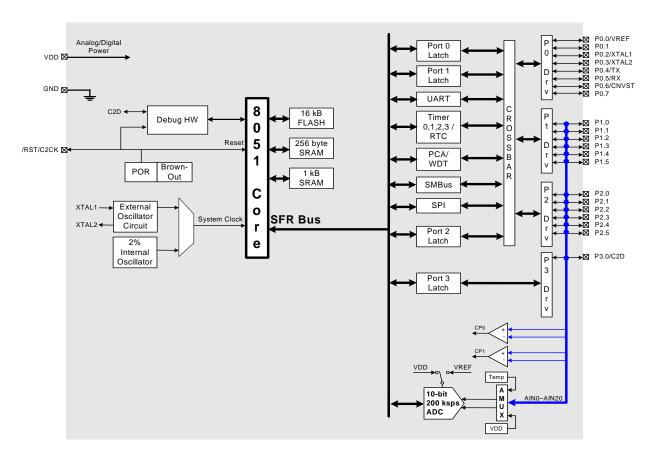
Figure 1.7. C8051F316 Block Diagram
