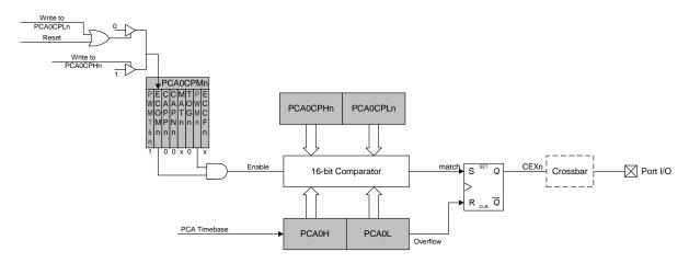
Figure 18.9. PCA 16-Bit PWM Mode
