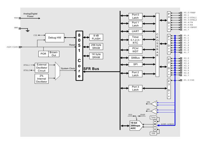
Figure 1.4. C8051F313 Block Diagram
