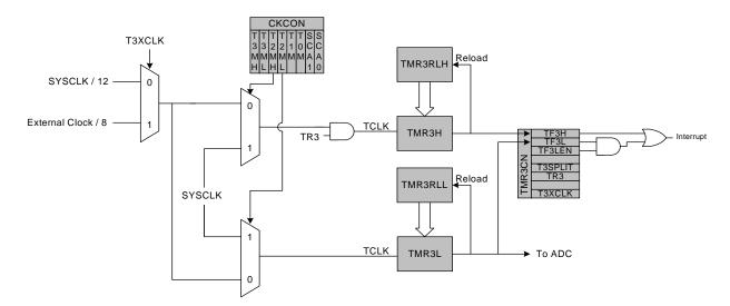
Figure 17.7. Timer 3 8-Bit Mode Block Diagram
