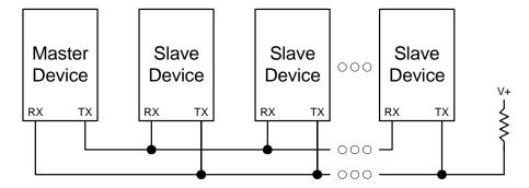
Figure 15.6. UART Multi-Processor Mode Interconnect Diagram
