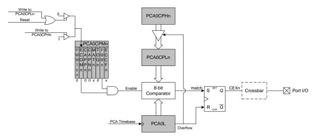
Figure 18.8. PCA 8-Bit PWM Mode Diagram
