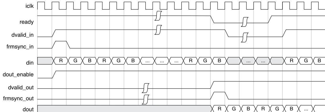
**Figure 2-6. RGB Parallel Deinterlacing (8-Bit Pixel)**
