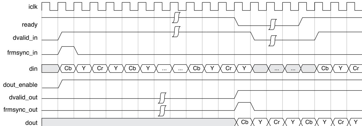
**Figure 2-8. YCbCr 4:2:2 Parallel Deinterlacing (8-Bit Pixel)**
