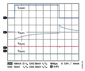
Figure 41. Load Transient Response,  $I_{LOAD1}=1~mA$  to 200~mA,  $I_{LOAD2}=I_{LOAD3}=1~mA$ ,  $CH1=I_{LOAD1}$ ,  $CH2=V_{OUT1}$ ,  $CH3=V_{OUT2}$ ,  $CH4=V_{OUT3}$ ,  $V_{RIPPLE}=50~mV$ ,  $C_{OUT}=1~\mu F$
