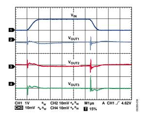
Figure 45. Line Transient Response,  $V_{IN}=4~V~to~5~V,~I_{LOAD1}=I_{LOAD2}=I_{LOAD3}=100~mA,~CH1=V_{IN},\\ CH2=V_{OUT1},~CH3=V_{OUT2},~CH4=V_{OUT3},~V_{RIPPLE}=50~mV,~C_{OUT}=1~\mu F$
