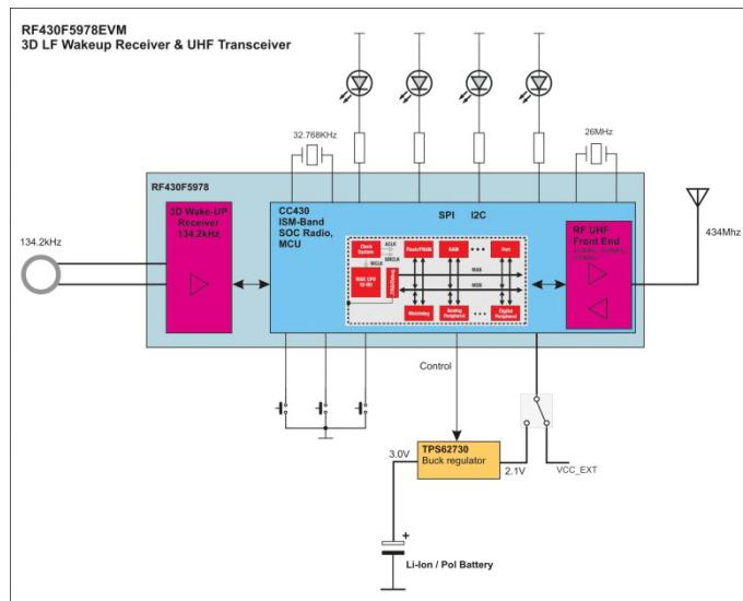
**Figure 2. RF430F5978EVM Block Diagram**
