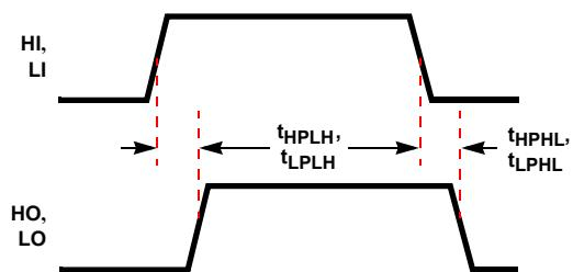
FIGURE 3. PROPAGATION DELAYS
