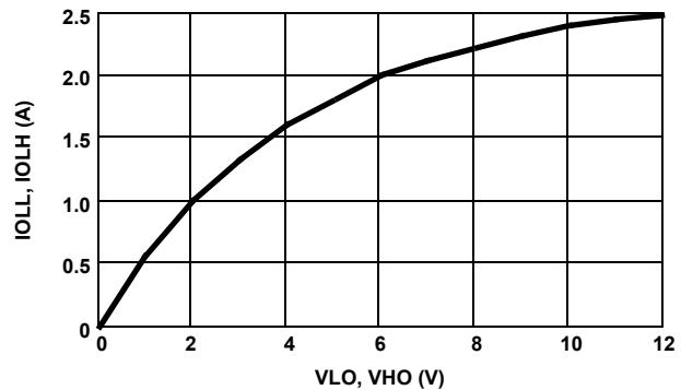
FIGURE 18. PEAK PULL-DOWN CURRENT vs OUTPUT VOLTAGE
