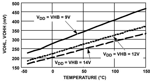
FIGURE 9. HIGH LEVEL OUTPUT VOLTAGE vs TEMPERATURE
