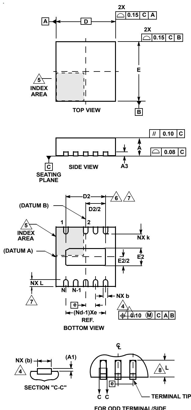
**L9.3x3****9 LEAD DUAL FLAT NO-LEAD PLASTIC PACKAGE**
