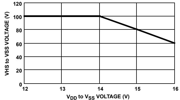
FIGURE 22. VHS VOLTAGE vs V<sub>DD</sub> VOLTAGE
