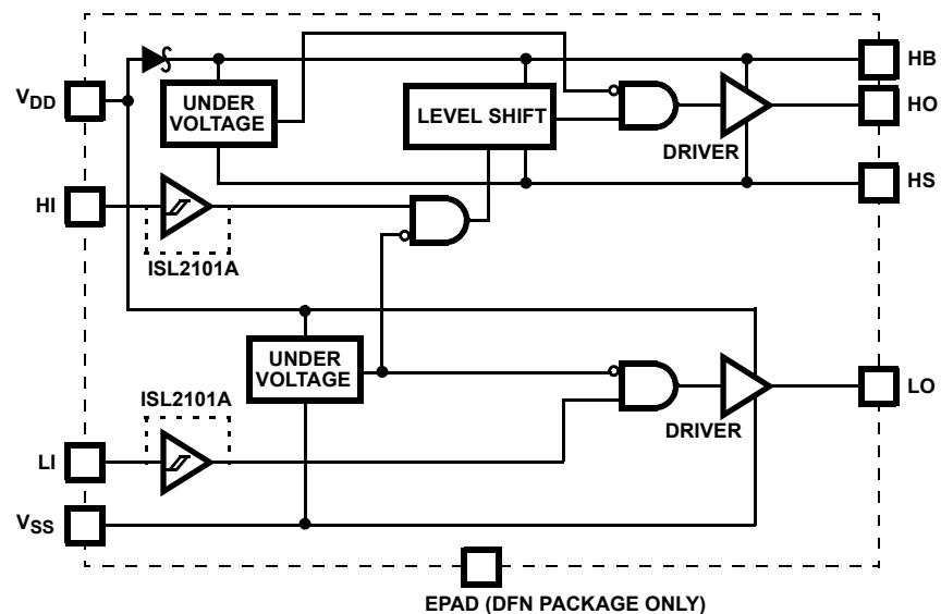
\*EPAD = EXPOSED PAD. THE EPAD IS ELECTRICALLY ISOLATED FROM ALL OTHER PINS. FOR BEST THERMAL PERFORMANCE CONNECT THE EPAD TO THE PCB POWER GROUND PLANE.
