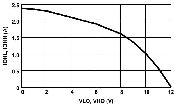
FIGURE 17. PEAK PULL-UP CURRENT vs OUTPUT VOLTAGE
