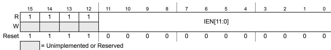
Figure 13-12. ATD Input Enable Register (ATDDIEN)
