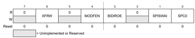
Figure 15-4. SPI Control Register 2 (SPICR2)
