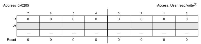
Figure 2-7. Module Routing Register 5 (MODRR5)
