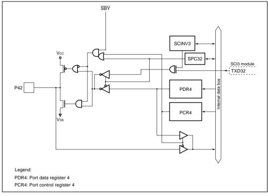
Figure B.2(b) Port 4 Block Diagram (Pin P42)
