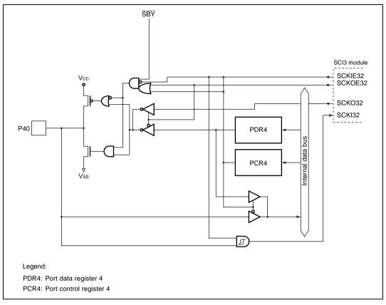
Figure B.2(d) Port 4 Block Diagram (Pin P40)
