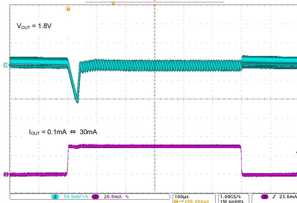
(2) XCL210B181GR-G,  $V_{IN}=3.6V$ ,  $V_{OUT}=1.8V$  /  $I_{OUT}=10mA \leftrightarrow 30mA$
